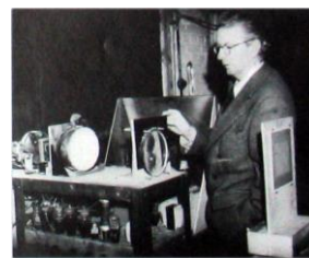
下左 ズヴォリキンのアイコノスコープ。光（赤）は光電性の電極に導かれ、この電極はうけた光に
