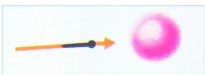
図解 1 ウラン 235 の比較的安定した原子核は余分な中性子を衝突させることによって、原子は一瞬のうちにきわめて不安定なウラン 236 に壊変する。
